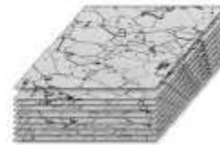
Подготовка полированных областей 2D конструкций через определенные промежутки, чтобы обеспечить 3D-реконструкцию материалов для анализа.
