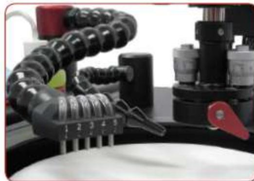
В удобном поворотном манипуляторе с форсунками предусмотрены насадки из нержавеющей стали, которые легко снимаются для очистки
