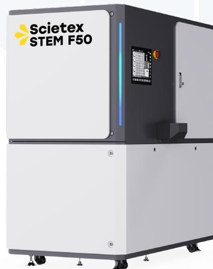
50 кВ полностью автоматизированный сканирующий просвечивающий электронный микроскоп (STEM) с запатентованной технологией съемки для быстрого анализа и морфологии биологических объектов с использованием алгоритмов искусственного интеллекта (AI). Отлично подойдет для исследований патологических срезов тканей, мозга и др.
