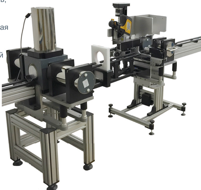
Система MSCL с установленным XRF-анализатором Olympus Delta, датчиками определения скорости P-волны, магнитной восприимчивости, спектрального естественного излучения, гамма-плотности
