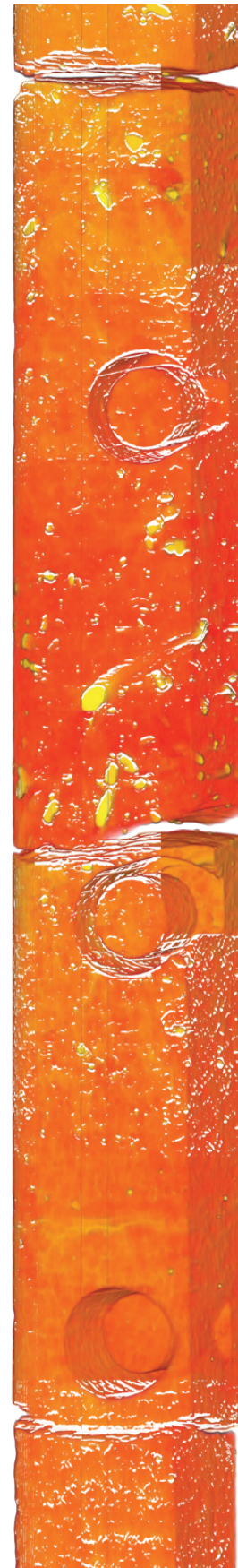
↑ Визуализация трёхмерных данных компьютерной томографии целого керна в ложном цвете. Подробное изображение пяти трехфутовых выровненных и сшитых сегментов цельного керна.
